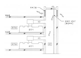
문제의 발생은 급기용 콘크리트 피트 내부에 있 었다. 정화조 통기관이 급기용 콘크리트 피트 내부 에 설치되어 있는데 용접 작업자가 통기관 입상 용 접작업을 소홀히 하여 통기관 용접부위의 틈새로 정화조 악취가 공조기 가동 시 실내로 유입되어 냄 새가 확산된 것이다.
