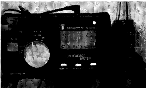
【그림 13】 저항성 누전전류와 용량성 누설전류에 대한 측정값을 흑백 LCD 화면에 표시한 일반형 누전분석기로 선로를 측정하고 있는 사진
