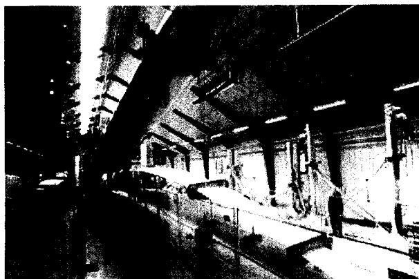
그림 7. 가진장치(RISO, 덴마크)를 이용한 단일축 방향(flapwise) 피로시험
