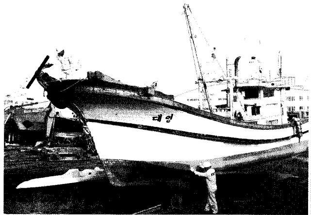
▲ 1중 중간검사(1대영호, 7.93톤급), 군산시 서해조선소
