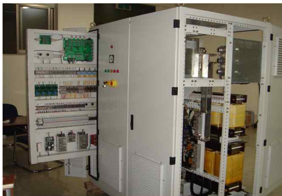
그림 11 실험에 사용한 DFIG 제어시스템 Fig. 11 experimental setup for DFIG system
