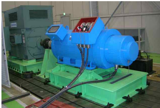
그림 10 실험에 사용한 Motor-DFIG 세트 Fig. 10 Motor-DFIG set for experiments
