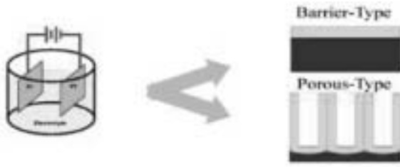
Fig. 16. 양극산화법에 의해 형성되는 수직형 기공채널 구조
