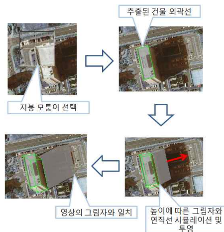
그림 1. 단일 고해상도 영상에서 건물의 그림자와 연직선 기반 건물 추출 과정
