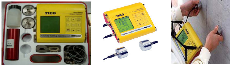
(a) 균열깊이 측정용 초음파 장비(TICO, proceq)
