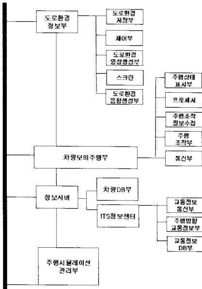
그림 3. 도로 주행 시뮬레이터 모듈 구성 Fig. 3. Elements of road driving simulator module
