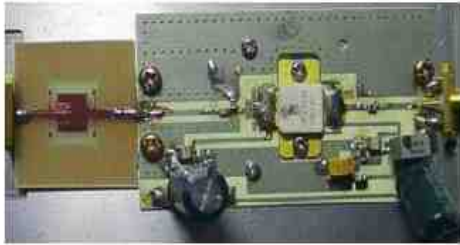
그림 4. 제작된 DGS가 적용된 AB급 전력증폭기
