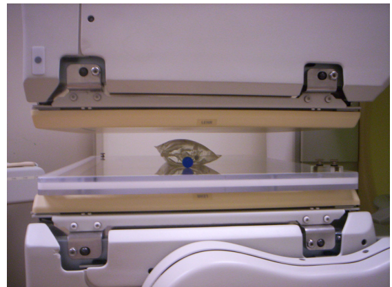
Fig. 2. 튜브팬텀과 flood팬텀의 설치(측면).
