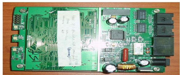
그림 4. VPN을 적용한 VoIP 단말기 H/W
