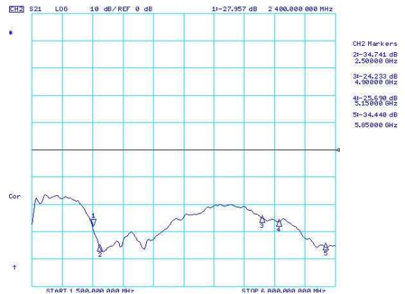
그림 10. 서로 직교한 두 안테나 간 Isolation(S21) Fig. 10 Isolation between orthogonal two antennas
