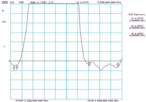
그림 8. 삼중 IFA의 튜닝후 측정 결과 Fig. 8 Measurement Result after tuning of Triple IFA
