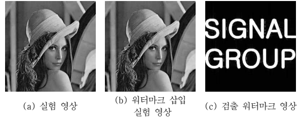
그림 9. 실험 영상, 워터마크가 삽입된 실험 영상 그리고 검출된 워터마크 영상 Fig 9. Experimental image, watermark inserted image and detected watermark image
