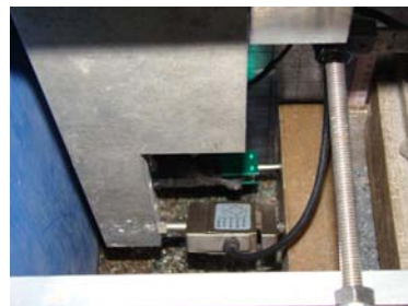
그림 5 계측기 및 수평재하장치 설치
