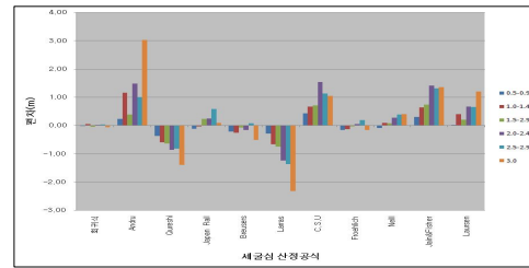
그림 5 교각 크기에 따른 실험 세굴심-세굴심 산정식 편차
