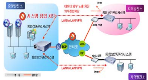
Fig. 6. The structure of unified security management system 그림 6. 통합 보안 관리시스템 구성도
