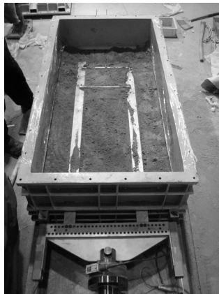
(a) 하부층 다짐 및 보강재 포설 (좌측 : 돌기형, 우측 : 천공강재스트립 + 지지부재)
