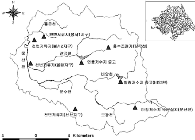
그림 1. 문산천 유역 내 설치 가능한 홍수방어 시설
