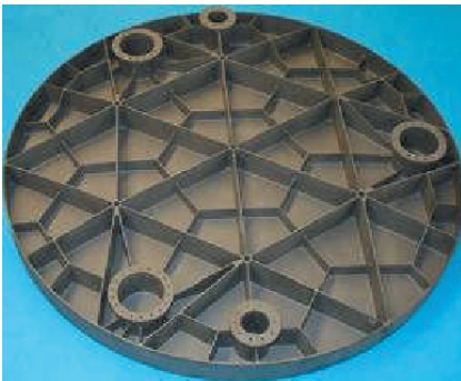
그림 10. Thales-Alenia-Space 와 ECM에서 HB-Cesic으로 제작한 600mm 반사경(4)
