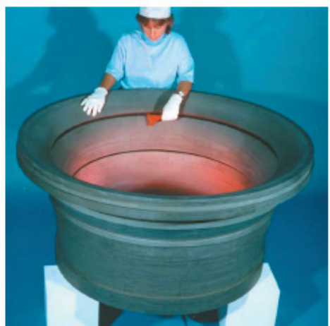
그림 9. C/C 복합재료로 제작한 Arian 5의 고체모터 부품(21)
