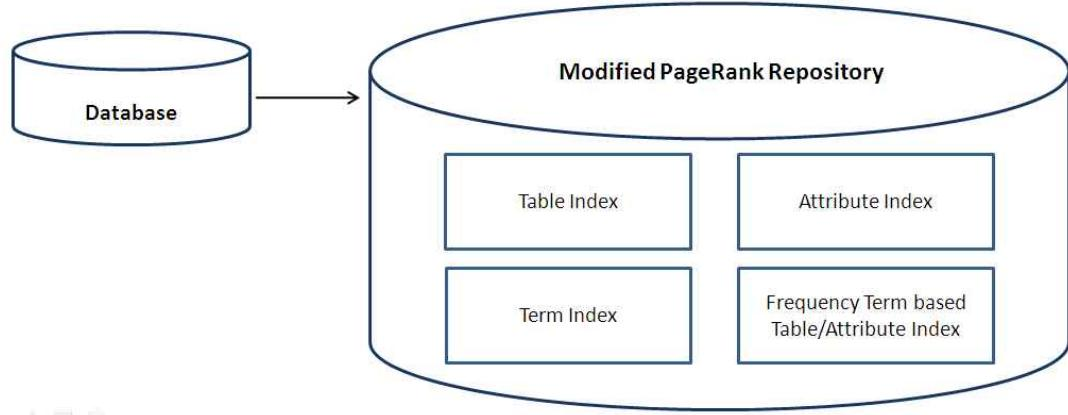
〈그림 3〉 TableRank 시스템 아키텍처
