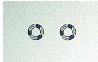
그림 3.3 에칭으로 제작된 체크밸브 형상
