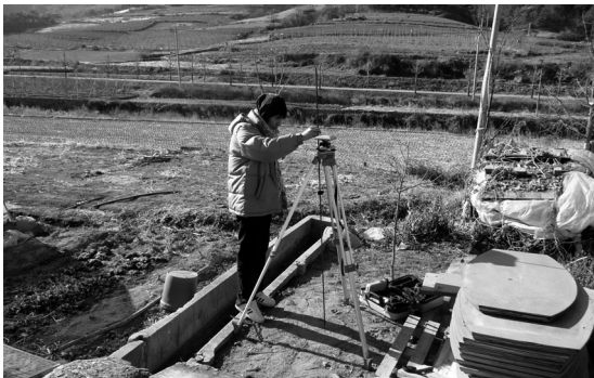
그림 7. 편심위치에서 GPS 측량 모습
