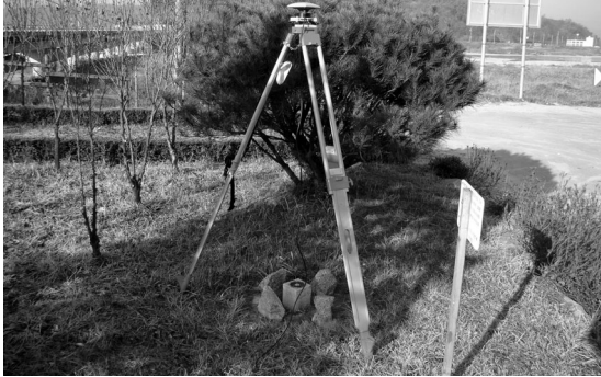
그림 6. 수준점에서의 GPS 측량 모습
