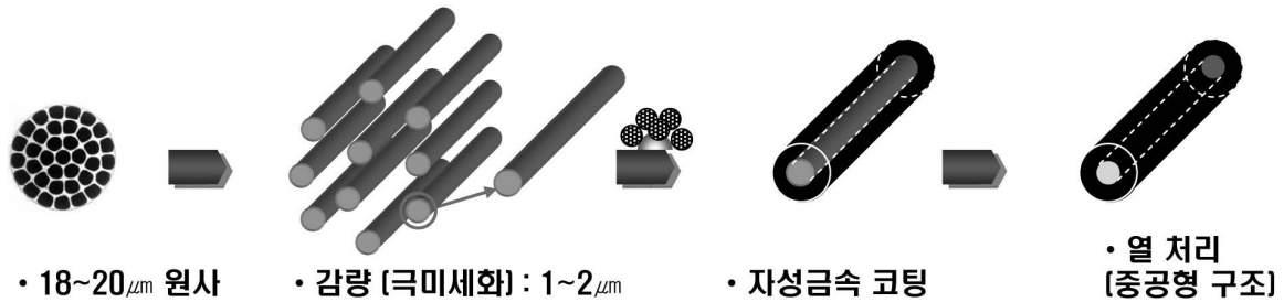
Fig. 6. 무전해 도금을 이용한 고각형비 자성입자 제조 개념도
