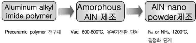
Fig. 6. Preceramic polymer 전구체를 이용한 AlN nano powder 제조 공정.
