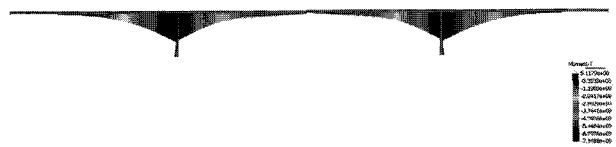
그림 11 PSC Frame 요소를 이용한 PSC교량의 해석결과 - 모멘트도
