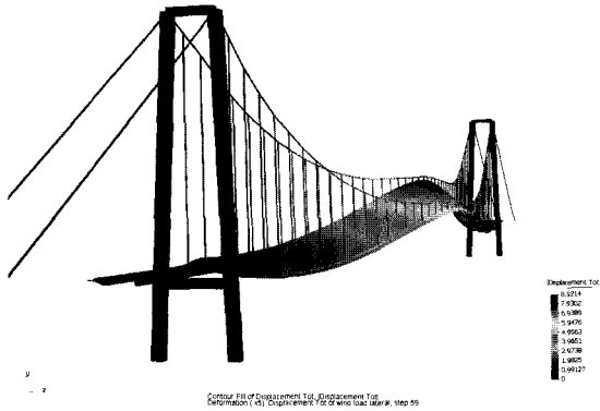
그림 25 뼈대요소를 이용한 현수교 보강형의 뒤틀림(와핑) 해석
