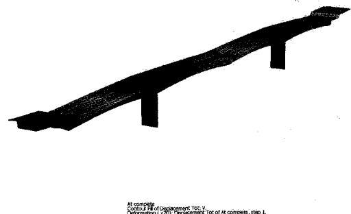
그림 12 PSC Shell 요소를 이용한 PSC교량의 해석결과 - 처짐
