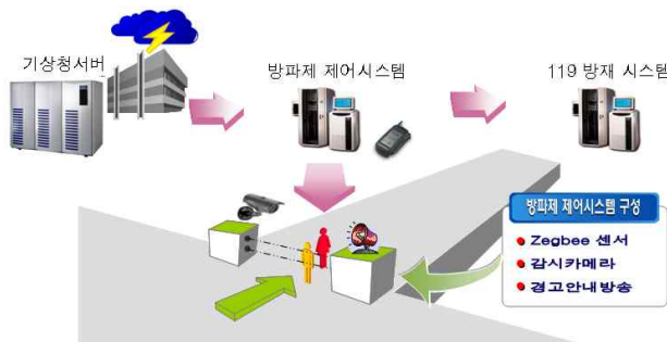
그림 1. 방파제 재난 방지 서비스 제공 흐름도 Fig 1. Service Flow for Breakwater Disaster Prevention System
