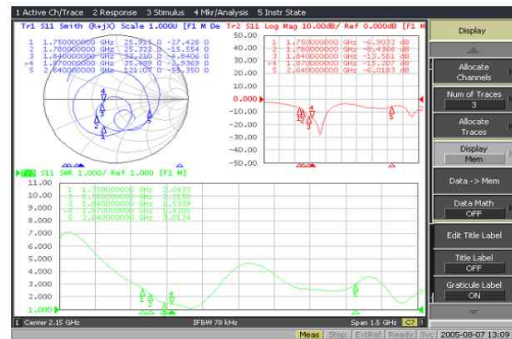
그림 3. PCS 대역 반사손실 측정 결과 Fig 3. Measured return loss of PCS band
