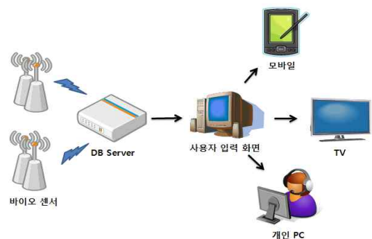
그림 6. 시스템 구성도 Fig. 6. system structure
