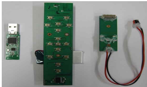
(좌부터 수신기, 송신기, 충전기) 그림 7. 손 동작 인식형 보조 입력장치 Fig. 7. Hand-action recognition based auxiliary input device
