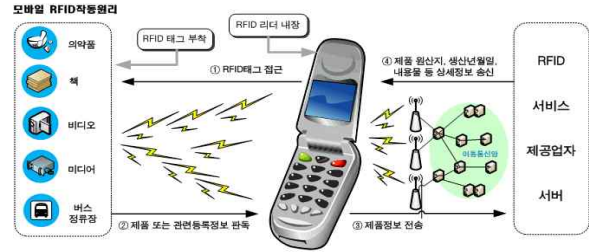
그림 2. 휴대폰과 연결된 RFID 시스템 Fig 2. RFID System Connecting to Cellular Phone.
