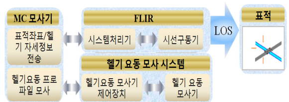
Fig. 17. 좌표지향 시험 시스템 구성
