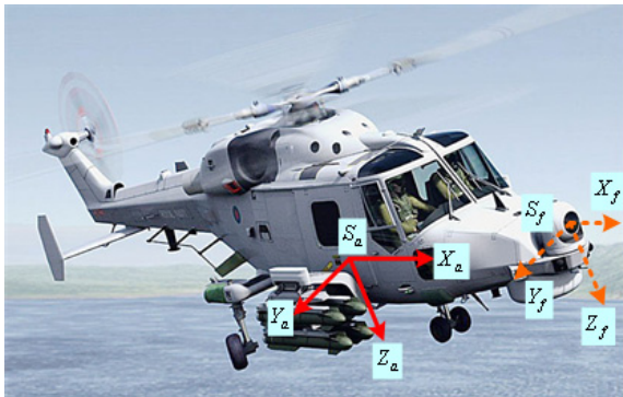
Fig. 8. 헬기 좌표계 및 FLIR 좌표계
