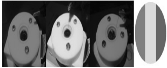
그림 2. 빛의 3원색을 쓰여주며 식각하는 과정. Fig. 2. Photos showing the etching process by using RGB colors.
