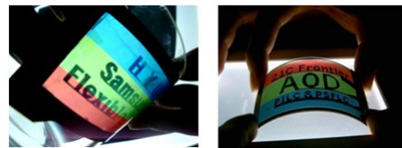
[그림 13] 플라스틱 안정화 모드를 활용한 LCD 시제품 (SPIE 2009 invited talk:한양대학교)
