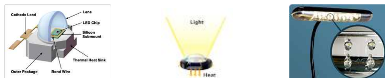
<그림 1> LED의 구조 및 LED 패키지와 LED 조명기기
