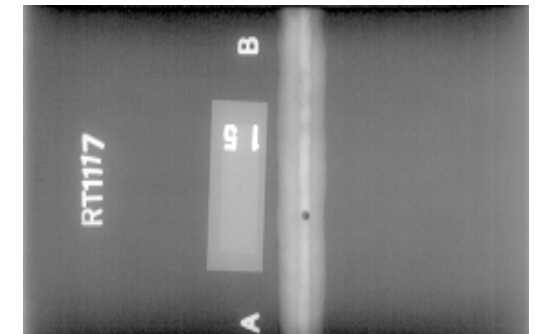
(d) Single gas pore defect image
