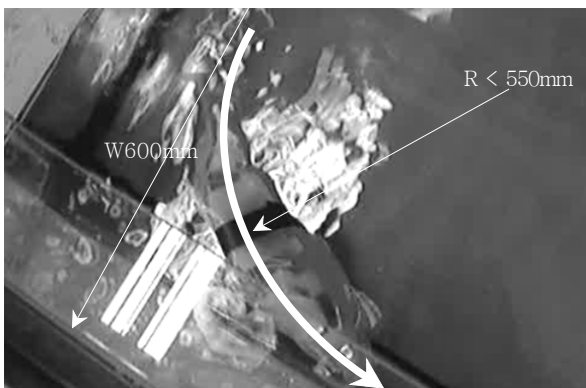
그림 9. 로봇물고기의 2단 Flapper를 이용한 회전(2).
