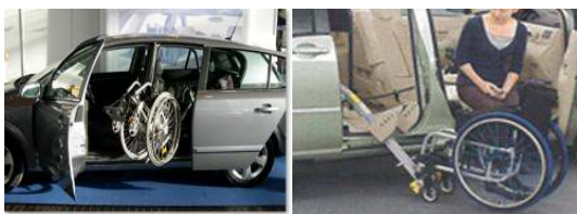
(e) 차량 뒷좌석에 휠체어 수납장치가 설치 (그림 출처: Toyota Welcap)
