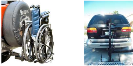
(b) 차량 후면 거치대에 설치
