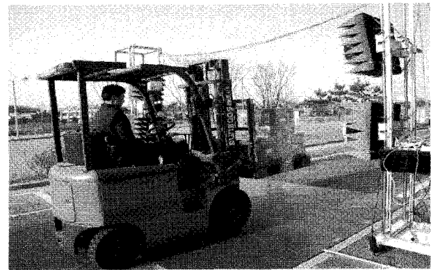
그림 5. RFID 성능시험을 위한 독도어 포탈
