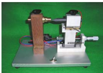
그림 3 직렬 아크 발생 장치 Fig. 3 Arc generator tester
