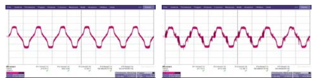
a) 정상전류(0.5A/div.) b) 아크고장전류(0.5A/div.) 그림 7 형광 램프의 정상전류와 아크고장 전류 Fig. 7 Normal and arc fault current from a FL.
