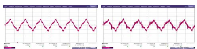
a) 정상 전류(1A/div.) b) 아크고장전류(1A/div.) 그림 8 냉장고의 정상전류와 아크고장 전류 Fig. 8 Normal and arc fault current from a refrigerator
