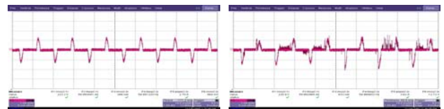
a) 정상전류(1A/div.) b) 아크고장전류(1A/div.) 그림 5 텔레비전의 정상전류와 아크고장 전류 Fig. 5 Normal and arc fault current from a TV
