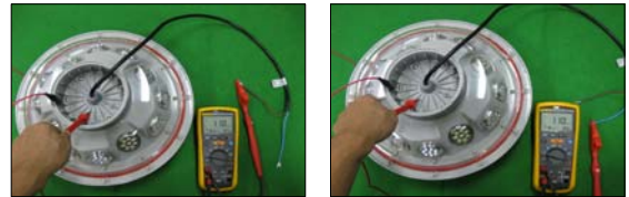
(a) LED 모듈단자와 외함 간의 절연 측정
