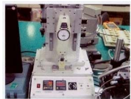
그림 6 배선 연결용 커넥터의 삽입력 시험 Fig. 6 Insertion power examination of connector for wiring connection
