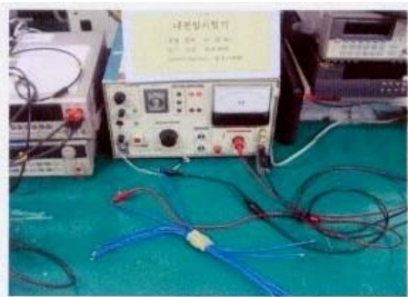
그림 5 배선 연결용 커넥터의 내전압 시험 Fig. 5 Withstand voltage test of connector for wiring connection
