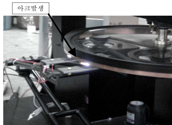
그림 4 이선으로 인한 아크 현상 Fig. 4 The arc phenomenon by contact loss
