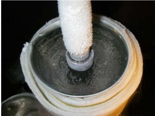
그림 3. 액체 질소를 이용한 -196^{\circ}\text{C} 인장시험
