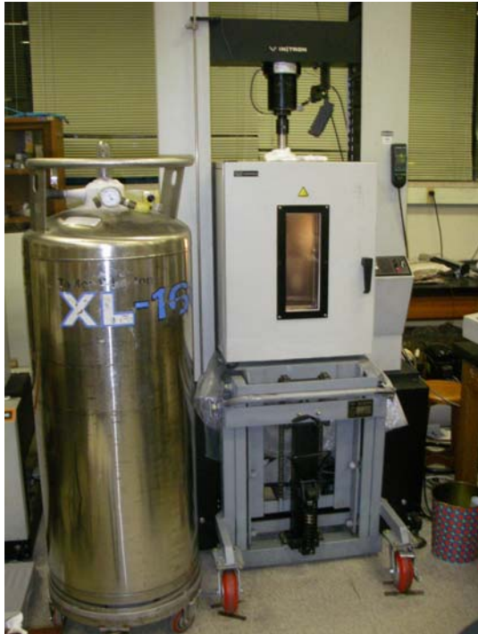
그림 1. 챔버를 이용한 저온 인장 시험 장비
