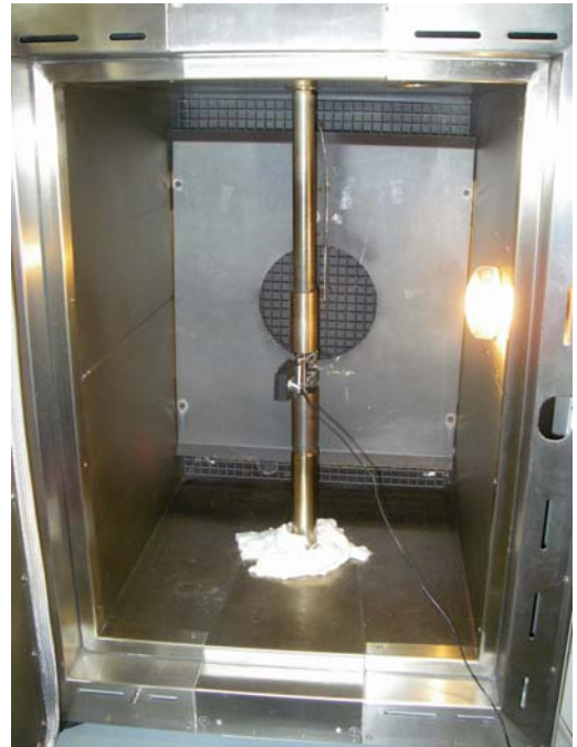
그림 2. 저온 챔버 내부의 형상과 변위계(extensometer)의 부착
