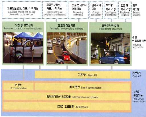
<그림 2> 일본 Smartway 노변장치 아키텍처 <Fig. 2> Smartway RSE architecture in Japan
