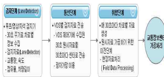
<그림 5> 차량검지기 자료 수집 과정 <Fig. 5> Information collection processor of vehicle detector
