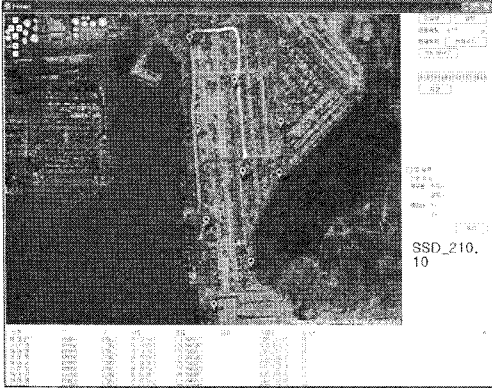
그림 10. Y/T의 이동 경로에 따른 AP 접속현황을 자체 분석 툴을 통해 확인 (측정시간: 15분)
