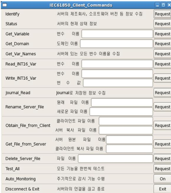
그림 9 IEC 61850 Client Simulator의 Command 윈도우 동작화면
