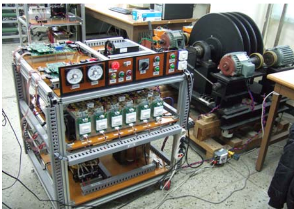
그림 12 NPC형 3레벨 인버터 축소모델 Fig. 12 Picture of the NPC type 3-level inverter system for experiment
