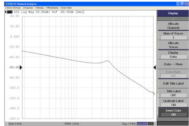
그림 15 피더스루 필터의 감쇄 특성 Fig. 15 Attenuation characteristics of the feedthrough filter
