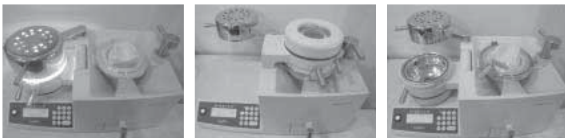
Fig. 2. 단층법으로 마우스가드 제작
